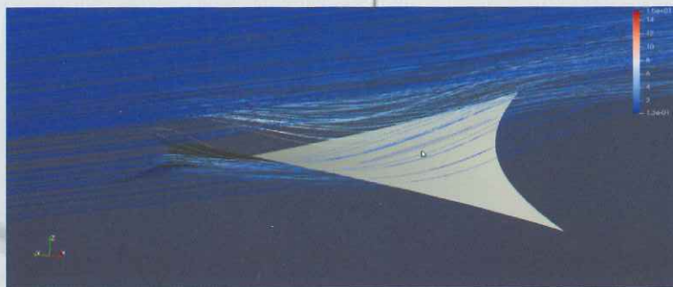
ウインドトンネル (CFD 解析) による膜面検討
